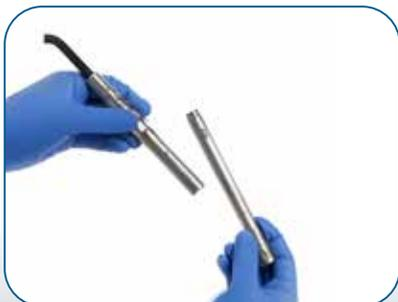
Elektronikmodul und Akku vor dem Autoklavieren entfernen
